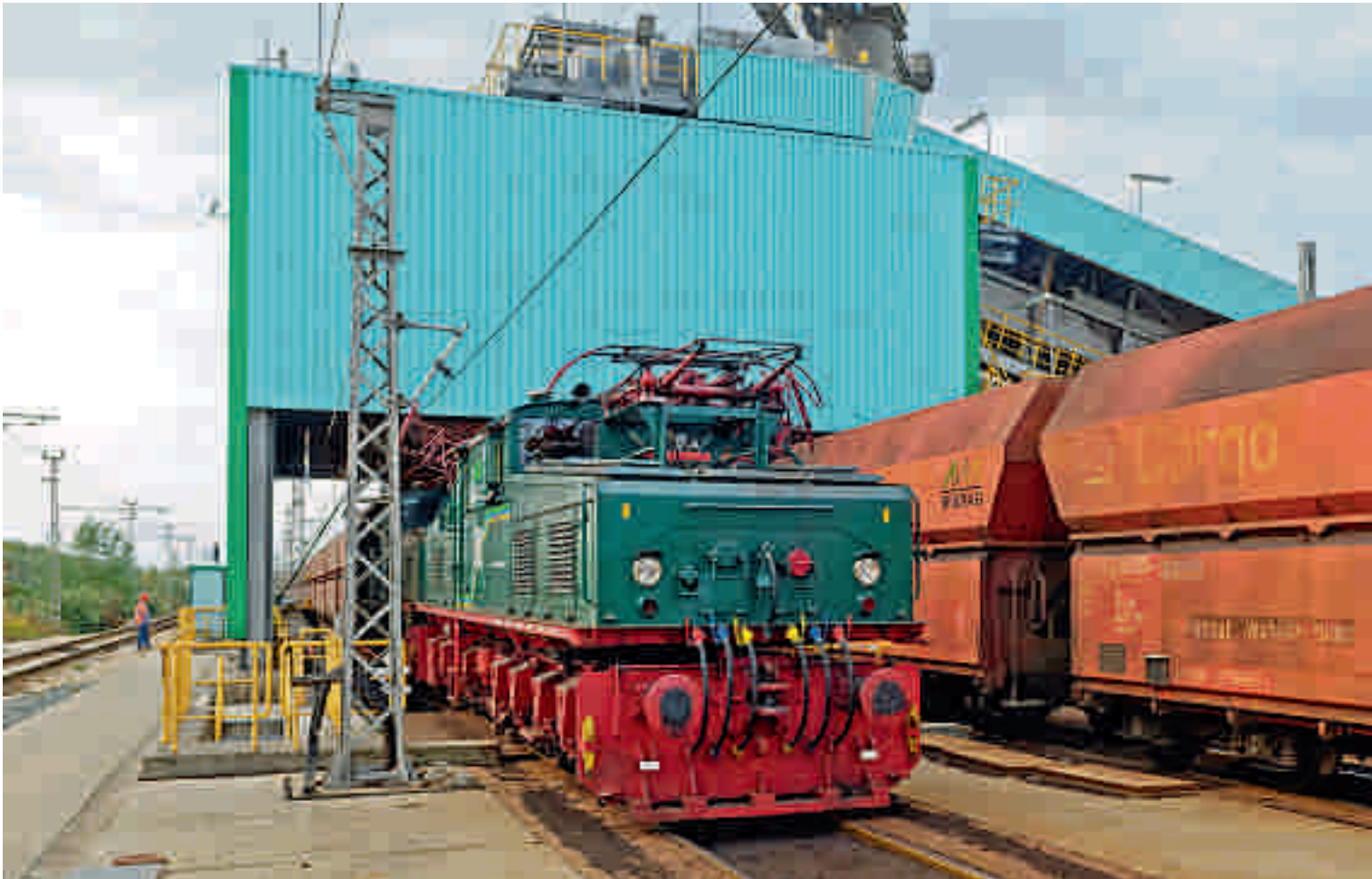
Blick in die Kohleverladung am Kohlenmisch- und Stapelplatz: Gut zu erkennen ist auf diesem Foto der Entfall des Seitenstromabnehmers auf der linken Seite des vorderen Vorbaus, der im Zuge der Modernisierung der EL 2 erfolgte. Der Seitenstromabnehmer auf den hinteren Vorbau ist dagegen weiterhin vorhanden, er wird für die Bewegung des Zuges unter der Verladung benötigt.
